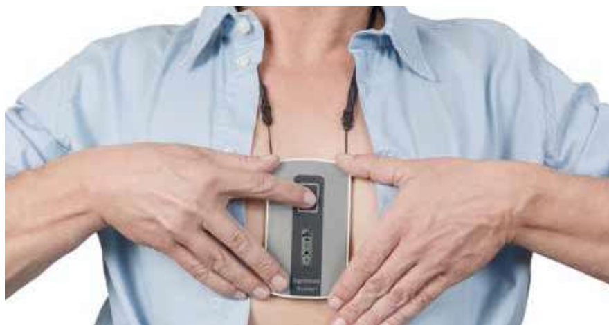
Tele-EKG-Gerät: Es erkennt Herzrhythmusstörungen.
